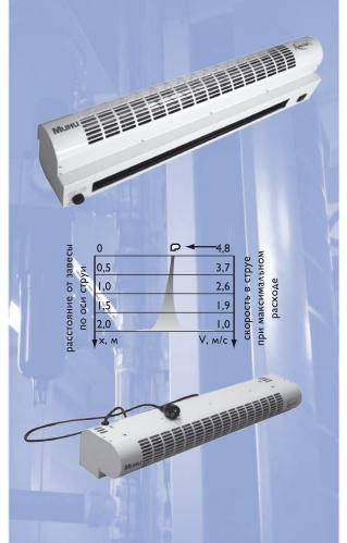
«Мини» - самые компактные завесы из всего ассортимента компании «Арктос», защищают малые дверные и оконные проемы размерами до 2 м в высоту, ширина проема — 0,8 м. Компактные размеры допускают установку в ограниченном пространстве между дверным проемом и потолком.
