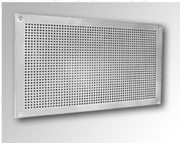
Воздухораспределитель ВСН предназначен для подачи приточного воздуха в помещение со ступенчатыми рядами кресел непосредственно под кресла. Для обеспечения комфорта людей, воздух подаётся с малой скоростью (с угасанием до  $\leq 0,2$  м/с на расстоянии 0,5...1,0 м от воздуховыпускной панели) и малым температурным перепадом ( $\Delta t \leq 3^\circ\text{C}$ ).
