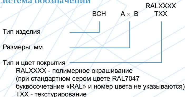
**Пример обозначения при заказе воздухораспределителя ВСН для установки в ступени с габаритами лицевой панели 500 x 300, цвет окраски стандартный RAL 7047:**
