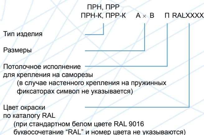
**Пример обозначения при заказе решётки ПРН-К для настенного крепления, размером 700 x 300, цвета RAL9015:**
