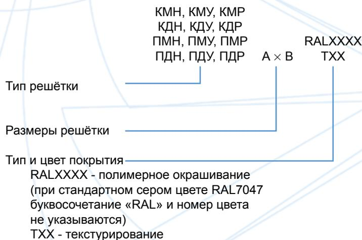
**Пример обозначения при заказе решётки КМУ размером 500 x 200 мм, цвет окраски RAL 1015:**
