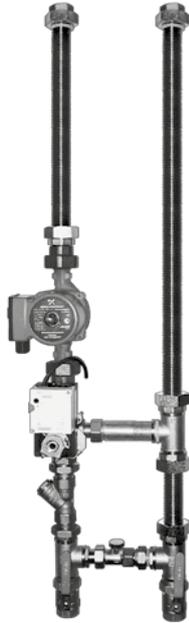
Смесительные узлы серии ZMP предназначены для регулирования мощности водяных нагревателей посредством трехходового клапана с приводом, который обеспечивает смешивание прямой и обратной воды, тем самым регулируя температуру теплоносителя на входе в теплообменник.
