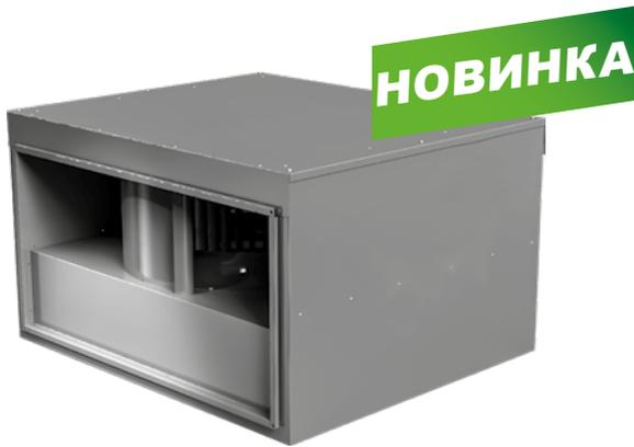
Вентиляторы ZKSA применяются для перемещения воздуха в прямоугольных каналах систем приточной и вытяжной вентиляции жилых, общественных, производственных помещений. Вентиляторы оснащены рабочими колесами с вперед загнутыми лопатками и двигателем с внешним ротором.
