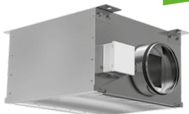
Вентиляторы ZKAM применяются для перемещения воздуха в круглых каналах систем приточной и вытяжной вентиляции жилых, общественных, производственных помещений. Вентиляторы оснащены рабочими колесами с вперед загнутыми лопатками и двигателем с внешним ротором.
