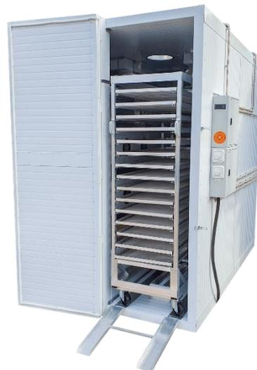
Сушильная камера (шкаф) КС-34 обладает повышенной вместимостью и предназначена для крупных производств. Рассчитана на помещение внутрь четырёх закатных тележек, что удобно для перемещения по цеху и закладки сырья рядом с рабочим столом, а также последующего хранения лотков. Поставляется как в полностью собранном виде, так и может быть смонтирована на месте в цеху.
