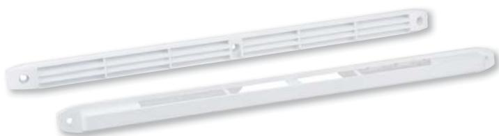
Саморегулирующиеся приточные клапаны с расходом воздуха 22, 30 и 45 м<sup>3</sup>/ч изготавливаются из полистирола белого или коричневого цвета. Приточные клапаны предназначены для установки на оконных рамах и обеспечивают приток воздуха в жилые комнаты (спальни, гостиные, столовые). Размер отверстия в оконной раме для установки клапана составляет 354x12 мм.
