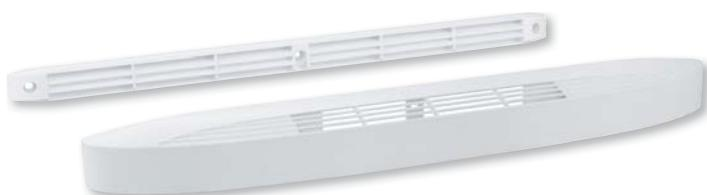
Саморегулирующиеся приточные клапаны с расходом воздуха 22, 30, 36 и 45 м<sup>3</sup>/ч изготавливаются из литого полистирола. Приточные клапаны предназначены для установки на оконных рамах и обеспечивают приток воздуха в жилые комнаты (спальни, гостиные, столовые). Размер отверстия в оконной раме для установки клапана составляет 354x12 мм.
