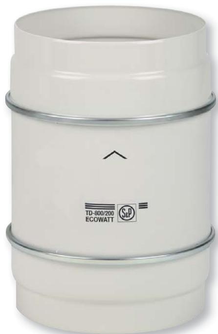
Круглые каналные вентиляторы TD ECOWATT комплектуются высокоэффективными электрокоммутируемыми двигателями и крыльчатками с диагональными лопатками. Корпуса и крыльчатки вентиляторов от 160 до 800 модели изготавливаются из высококачественного пластика, у моделей 1300 и 2000 корпуса - из стали, крыльчатки - из алюминия. Конструкция корпуса вентилятора позволяет извлекать блок двигатель-крыльчатка без демонтажа воздуховодов.
