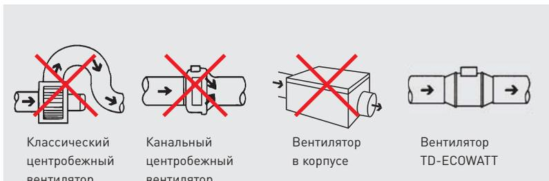
Компактная конструкция и высокая производительность вентиляторов TD-ECOWATT делает их незаменимыми при монтаже в ограниченном пространстве, например, за подвесным потолком.
