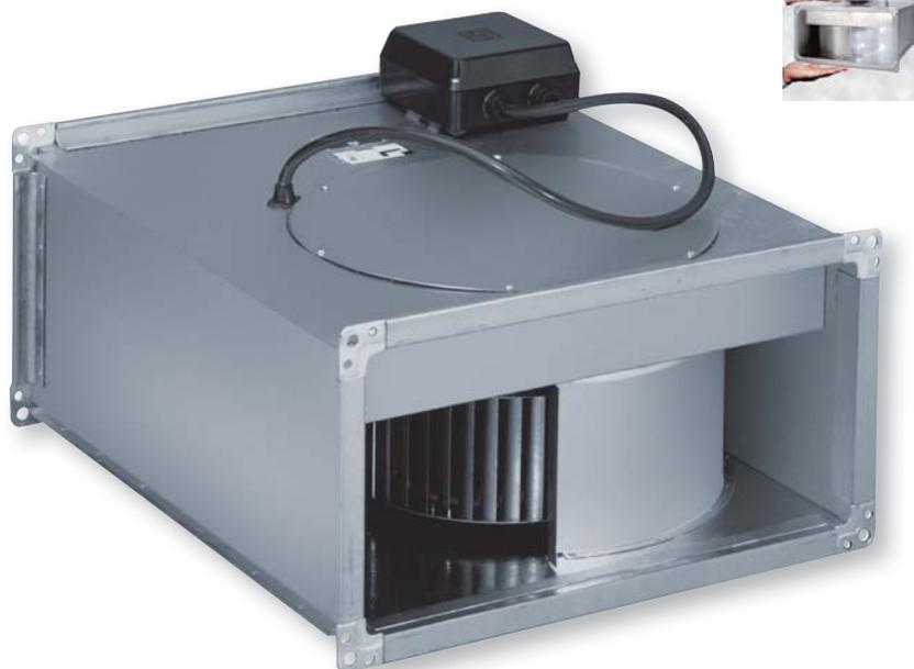
Прямоугольные каналные вентиляторы серии ILB/ILT оснащаются рабочими колесами с загнутыми вперед лопатками. Корпус и рабочее колесо вентилятора изготавливается из оцинкованной листовой стали. Вентиляторы укомплектованы инспекционной крышкой для доступа к электродвигателю и рабочему колесу, что позволяет проводить осмотр и обслуживание внутренних частей вентилятора прямо на месте установки, без его демонтажа.
