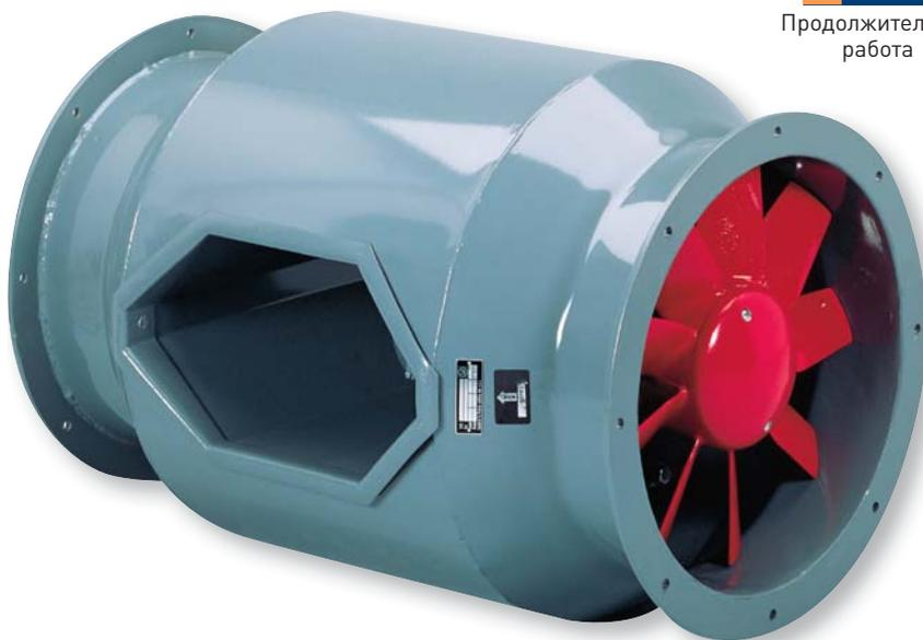
Осевые вентиляторы серии TET предназначены для продолжительной работы при температуре перемещаемого воздуха до +150°C. Конструкция корпуса вентилятора позволяет разместить электродвигатель вне потока перемещаемого воздуха, при этом крыльчатка находится на валу электродвигателя.
