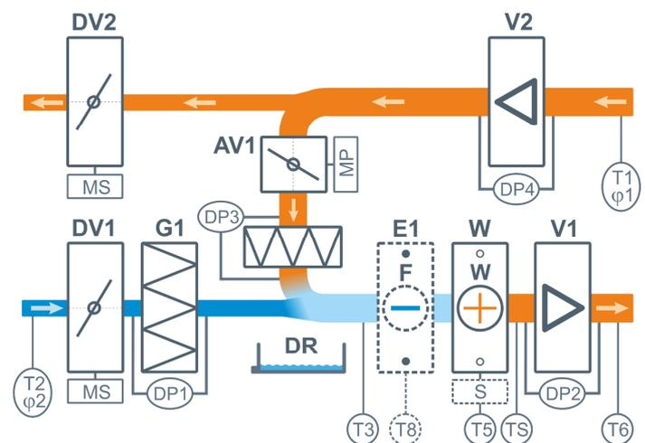
Для регионов с жарким и влажным климатом установка может комплектоваться фреоновым охладителем, работающим в режиме охлаждения и осушения приточного воздуха, а также выходом для управления ККБ (опция CF).
