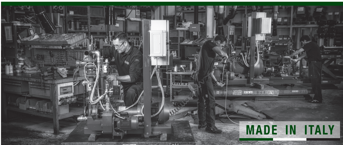
ПРОТИВОПОЖАРНАЯ НАСОСНАЯ СТАНЦИЯ С НАСОСОМ С ЭЛЕКТРОДВИГАТЕЛЕМ+ЖОКЕЙ-НАСОС
