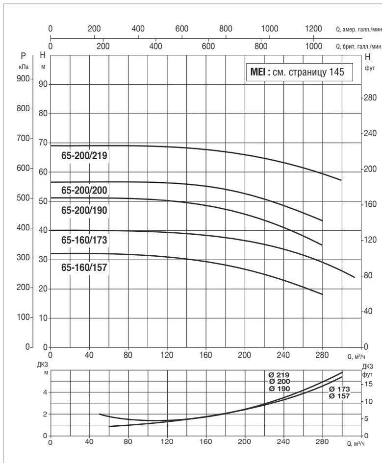
Кривые производительности основаны на значениях кинематической вязкости, равной 1 мм<sup>2</sup>/с. и плотности, равной 1000 кг/м<sup>3</sup>. Погрешность кривых соответствует ISO 9906.
