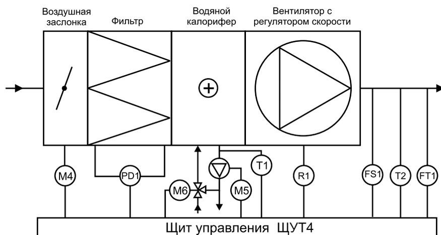
Для вентиляторов 4 и 5, 5 кВт в щите установлены реле защиты по термодатчикам TP220. Остальные двигатели защищаются от перегрузки по току.
