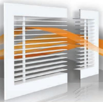
Вентиляционная нерегулируемая жалюзийная решетка ЛСП изготовлена из алюминиевого профиля в виде рамки и жестко закрепленных под углом 90° к лицевой поверхности изделия горизонтально расположенных жалюзи.
