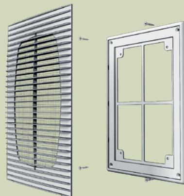
Типовой пример монтажа решётки П с помощью шурупов
