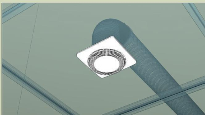
Возможен монтаж вентилятора, оснащенного опцией **BB**, в потолок или другие горизонтальные поверхности
