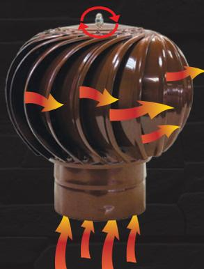
Несмотря на направление, силу и вид ветра, турбинная головка всегда вращается в одном направлении, и в дымовой трубе всегда создается частичный вакуум, что в результате ведет к интенсивности течения в трубе, значительно улучшая воздухообмен и исключая обратную тягу. Что также предотвращает проникновение внешних осадков (дождя, снега) в дымовой канал.
