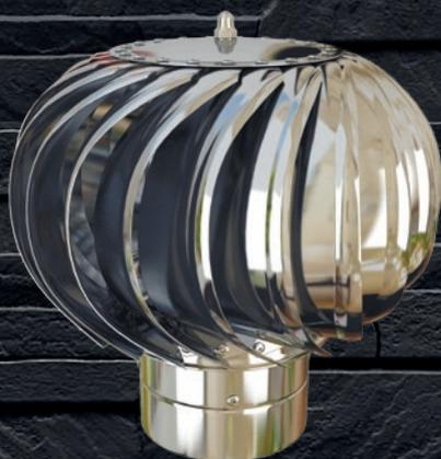
Дефлектор - это элемент естественной вентиляции, предназначенный для втягивания воздуха из помещений, не требующий подключения к электрической сети. Изделие работает, используя природный источник энергии - ветер. Благодаря вращению, дефлектор создает разрежение и вытягивает воздух из помещений, подкровельного пространства, вентиляционных каналов и шахт.
