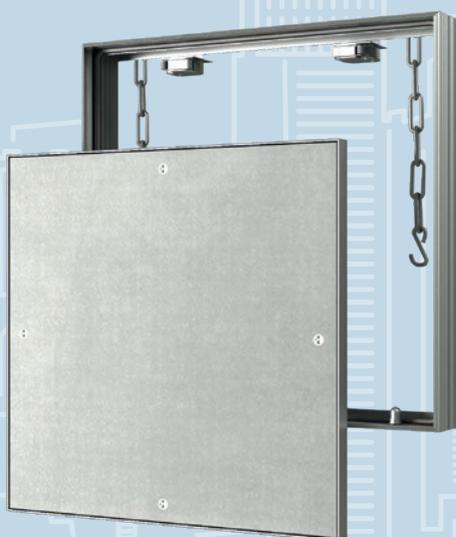
Ревизионные люки под плитку со съемной дверцей используются, когда перед ревизионным проемом есть препятствие (раковина, ванная, биде, стиральная машина). Дверца люка открывается нажатием в его верхней части под углом и удерживается в нижней части люка на стальных штырях. Дверца с наклеенной на нее плиткой вынимается из несущей рамы люка и откладывается в сторону, для этого ее нужно аккуратно приподнять вверх и снять с направляющих стальных опор.
