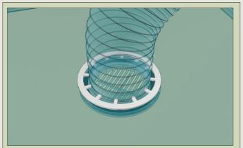
Гибкие воздуховоды серии **AF**, **AF-П** и **AFизо** могут крепиться к воздухораспределителям с помощью стопорного кольца **LR**
