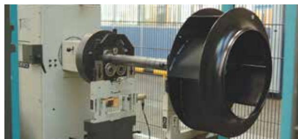
Рабочие колеса с загнутыми назад лопатками Меньше подвержены отложению пыли на лопатках. Динамически сбалансированы.
