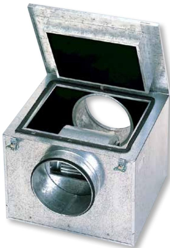
Вентиляторы в шумоизолированном корпусе из оцинкованной листовой стали с теплозвукоизоляцией из негорючего стекловолокна (М0) толщиной 50 мм. Крышка вентилятора крепится при помощи специальных защелок, которые обеспечивают плотное прилегание крышки к корпусу вентилятора. Вентиляторы комплектуются центробежными рабочими колесами с загнутыми вперед лопатками. Рабочие температуры от -20°C до +40°C.
