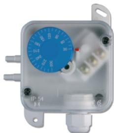
Регулируемое реле перепада давления предназначено для контроля перепада давления воздуха или других негорючих и неагрессивных газов. Возможное использование: контроль состояния воздушных фильтров или вентиляторов, контроль за потоком в вентиляционных каналах.
