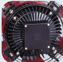
Внешняя клеммная коробка изготовлена из огнеупорного пластика с кабельным вводом PG-11 (в моделях с однофазными электродвигателями в коробке установлен конденсатор).
