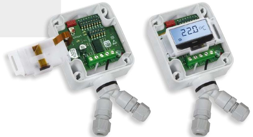
**Thermasgard® RPTM 2 - Modbus** – Преобразователь температуры в помещении измерительный маятникового типа (с шаровым датчиком)
