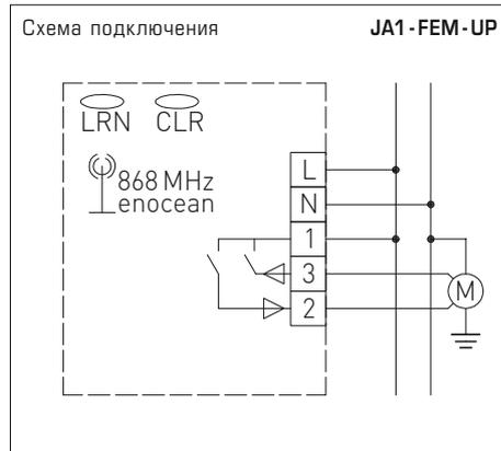
**KYMASGARD® JA1 - FEM - UP — Исполнительное устройство для управления жалюзи**
