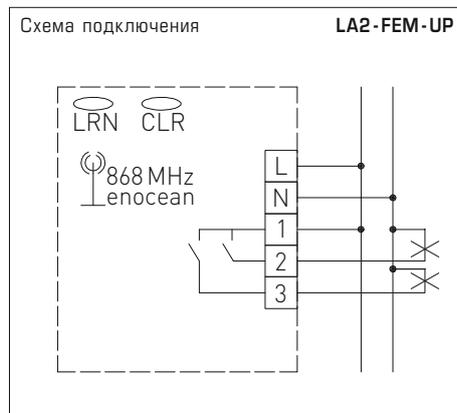
**KYMASGARD® LA2-FEM-UP — Коммутатор нагрузки**
