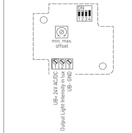
**PHOTASGARD® ANKF – Датчик освещенности / затемнения наружный**
