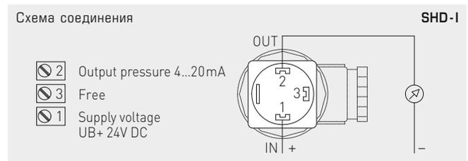
**PREMASGARD® SHD** – Преобразователь давления измерительный, *Premium*
