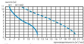
M1: производительность 1 мотора M1+M2: производительность 2 моторов
