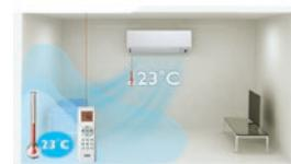
При активации этой функции кондиционер отслеживает температуру в помещении с помощью датчика, который расположен в пульте дистанционного управления. Если пользователь положит пульт рядом с собой, то комфортная температура будет обеспечена непосредственно в той части комнаты, где он находится.
