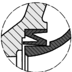
геометрия ходовых колец – рабочий режим
