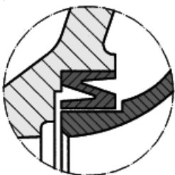
геометрия ходовых колец при отсутствии давления
