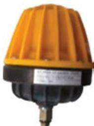
Гаситель гидроудара KIT PRESS AIR предназначен для минимизации воздействия резких скачков давления в напорной магистрали (гидроударов) на гидравлику насосов и трубопроводные элементы, а также для обеспечения корректной работы встроенных датчиков давления насосных станций и блоков контроля потока.
