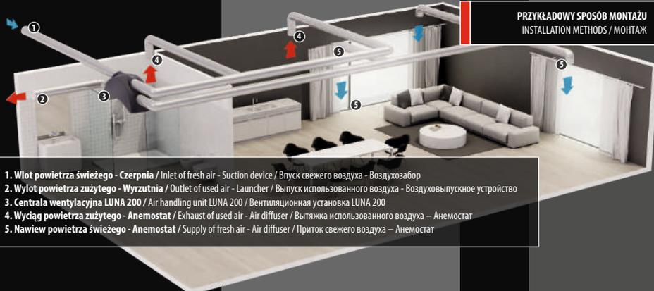
1. Wlot powietrza świeżego - Czerpnia / Inlet of fresh air - Suction device / Впуск свежего воздуха - Воздухозабор
