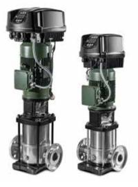
Вертикальные многоступенчатые центробежные насосы NKVE 1, 3, 6, 10, 15, 20 S от DAB из нержавеющей стали AISI 304, с муфтой и преобразователем частоты МСЕ-Р, спроектированы для повышения давления в жилых и коммерческих помещениях. Их также можно использовать в сельском хозяйстве в системах полива и орошения. Наличие ПЧ обеспечивает высокую эксплуатационную гибкость, позволяя насосу автоматически подстраиваться под различные требования системы и поддерживать в ней постоянное давление.
