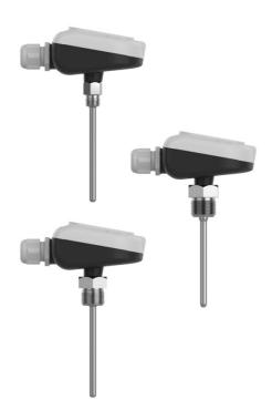
Погружные (врезные) датчики температуры в корпусе с защитой IP 65 из ABS-пластика выпускаются с присоединительной резьбой 1/4, 1/2 дюйма и M20x1,5, датчики выполнены из высококачественной нержавеющей стали AISI 304/316 и предназначены для измерения температуры жидкостей в инженерных системах, таких как вентиляция, кондиционирование, отопление, холодоснабжение, резервуары и жидкостные баки.
