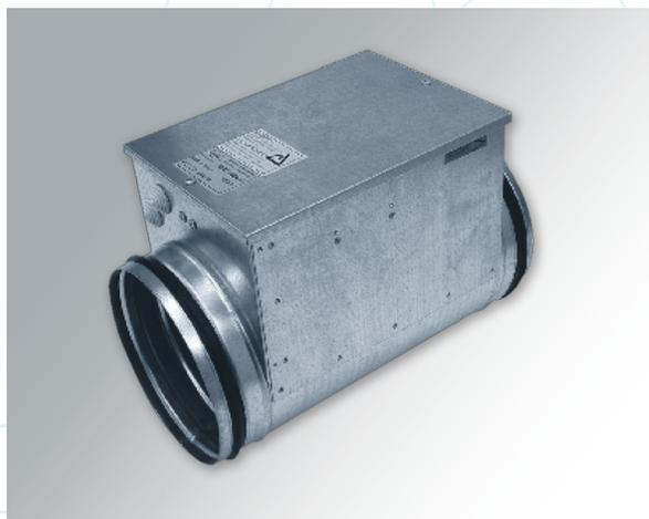
Канальные нагреватели РВЕС предназначены для подогрева воздуха в воздуховодах круглого сечения. Корпус и коммутационная коробка изготовлены из оцинкованной стали, нагревательные элементы — из нержавеющей стали. Степень защиты: IP 40.
