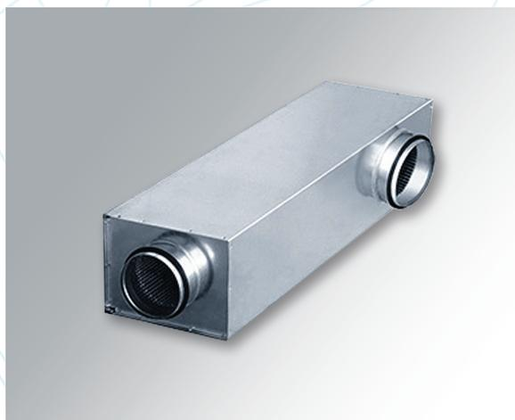
Шумоглушители CSV и CSH предназначены для снижения аэродинамического шума в воздуховодах круглого сечения. Шумоглушители разработаны для монтажа в ограниченном пространстве, когда нет возможности разместить все вентиляционное оборудование в линию. Шумоглушители устанавливаются независимо от направления движения воздуха, но при этом рекомендуется устанавливать в воздуховод таким
