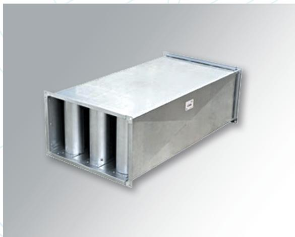
Пластинчатые шумоглушители RSA предназначены для снижения аэродинамического шума в воздуховодах прямоугольного сечения. Шумоглушители устанавливаются независимо от направления движения воздуха. Для достижения максимальной эффективности шумоподавления перед шумоглушителем рекомендуется предусмотреть прямолинейный участок длиной не менее 1 м.
