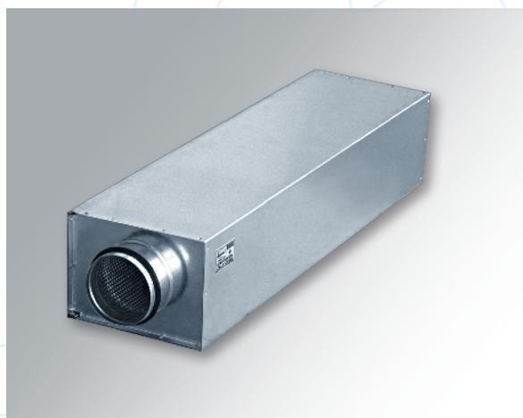
Шумоглушители CSR предназначены для снижения аэродинамического шума в воздуховодах круглого сечения. Шумоглушители разработаны для монтажа в ограниченном пространстве и имеют малую габаритную высоту. Шумоглушители устанавливаются независимо от направления движения воздуха.
