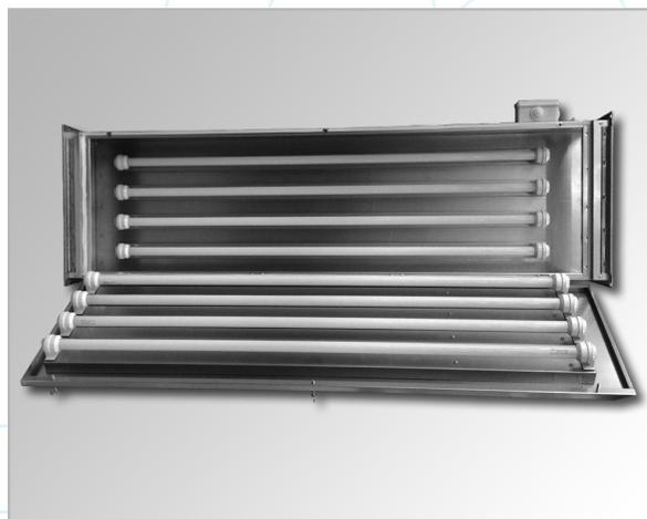
Фильтры ФБО предназначены для бактерицидной обработки проходящего через него приточного или рециркуляционного воздуха посредством воздействия на проходящий поток ультрафиолетового излучения. Таким образом, бактерицидная обработка воздуха осуществляется непосредственно в канале воздуховода и не требует специальных мер безопасности для людей, находящихся в помещении.
