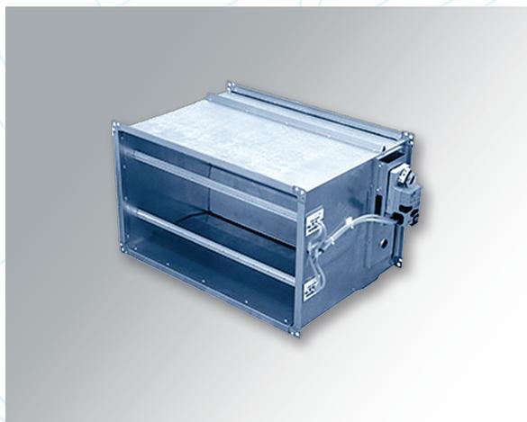
Регуляторы переменного расхода воздуха КППР для воздуховодов прямоугольного сечения предназначены для поддержания заданного значения расхода воздуха в системах вентиляции с переменным расходом воздуха (VAV) или с постоянным расходом воздуха (CAV). В режиме VAV уставка расхода воздуха может изменяться с помощью сигнала от внешнего датчика, контроллера или от системы диспетчеризации, в режиме CAV регуляторы поддерживают заданный расход воздуха.
