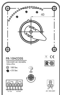
**Электропривод с возвратной пружиной для управления противопожарными клапанами (нормально-открытыми и нормально-закрытыми)**
