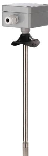
Датчик THS-02 измеряет относительную влажность и температуру воздуха посредством измерительного элемента с высокой долговременной стабильностью, расположенного внутри фильтра из прессованного металла на конце защитной трубки. Измеренные величины влажности и температуры преобразуются в нормированный сигнал 0-10В.
