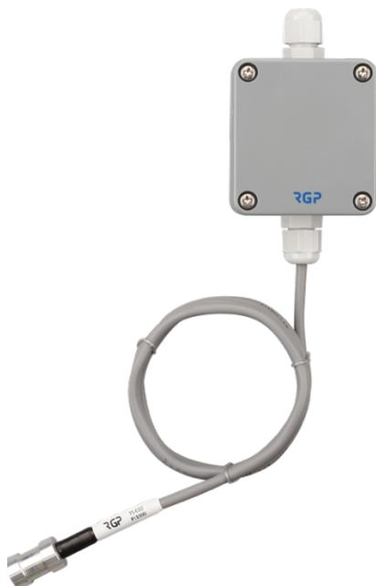
Датчик температуры TS-C02 является накладным термометром сопротивления с пассивным выходом, коробчатым корпусом из пластика и вынесенным за пределы измерительным элементом и применяется для измерения температуры поверхности трубопроводов. Исполнение датчика позволяет применять его на улице и во влажных помещениях (степень защиты IP67).
