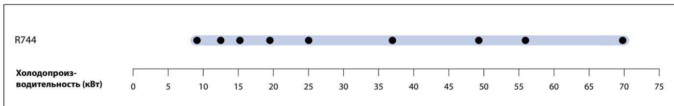
Условия: EN12900 R744: кипение –10 °С, выход из охладителя газа: 35 °С/90 бар, перегрев: 10 К
