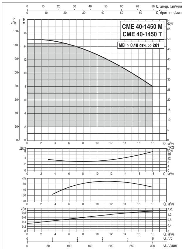
Значения MEI для насосов, регулируемых инвертором, относятся также к аналогичным вариантам исполнения насосов без электронного блока. Кривые производительности основаны на значениях кинематической вязкости = 1 мм²/с и плотности, равной 1000 кг/м³. Погрешность кривых соответствует ISO 9906.
