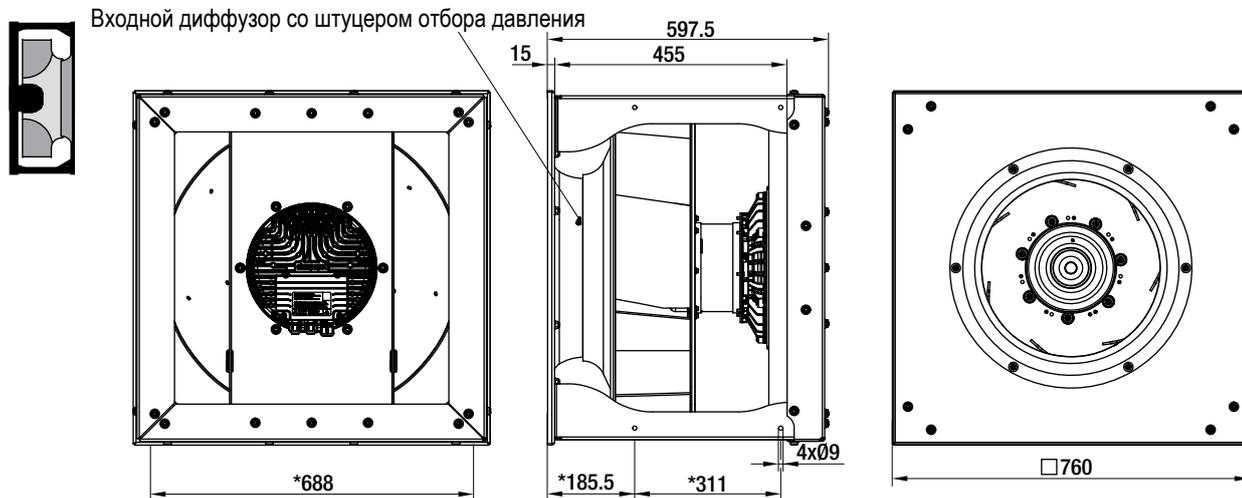
\* Позиция привинчивания колебательных или пружинных элементов, при горизонтальном положении вала допускается только напольная установка.
