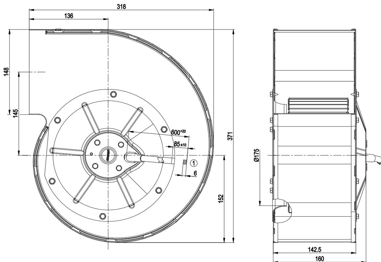
1 Соединительный провод, силиконовый, 6G 0,5 мм<sup>2</sup>, с заделкой 6 зажимами
